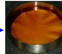
フェノール樹脂注入
