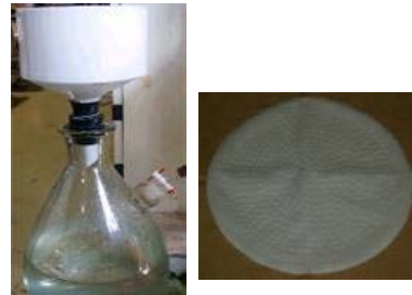
減圧濾過・シート化
